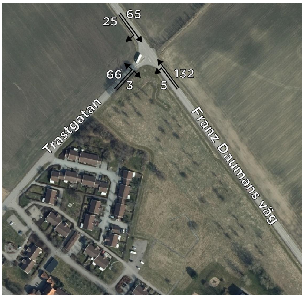
Figur 3. Svängrörelser i korsningen mellan Trastgatan och Franz Daumans väg under maxtimmen på förmiddagen.
