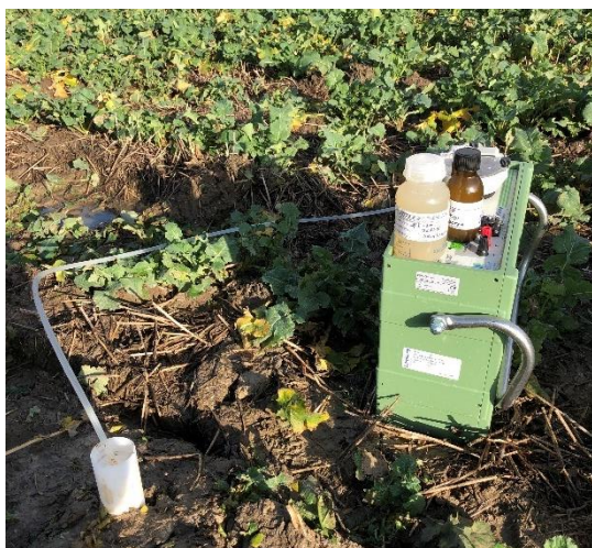
Figur 6. Fotot visar grundvattenprovtagning som utfördes med peristaltisk pump.
